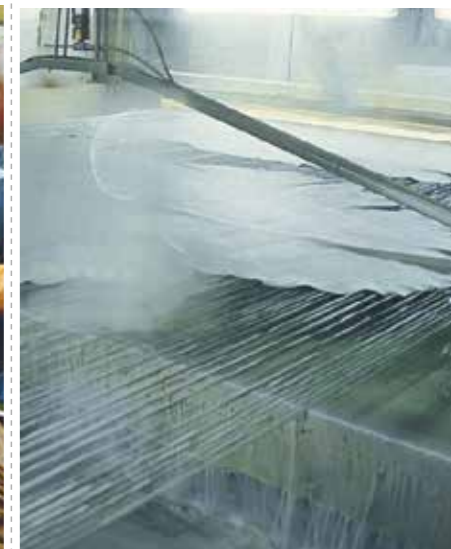
Nach dem Gerben der Häute in großen, rotierenden Fässern zeigt sich die Haut in bläulicher Farbe: „Wetblue“ – nassblau – ein Gerberbegriff für diesen Zustand. Danach werden die Leder in den gewünschten Farben eingefärbt.
