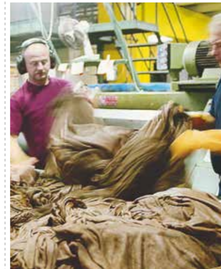
Im sogenannten Äscherprozess werden die Haare herausgelöst. Die Häute werden für die eigentliche Gerbung vorbereitet.
